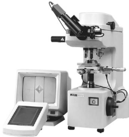
Figura 1.7: Microdurómetro modelo HM-125.
