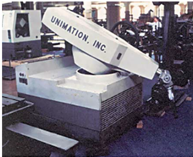
Figura 1.1: Primer Robot Industrial creado por la compañía Unimation en 1954 [2]
