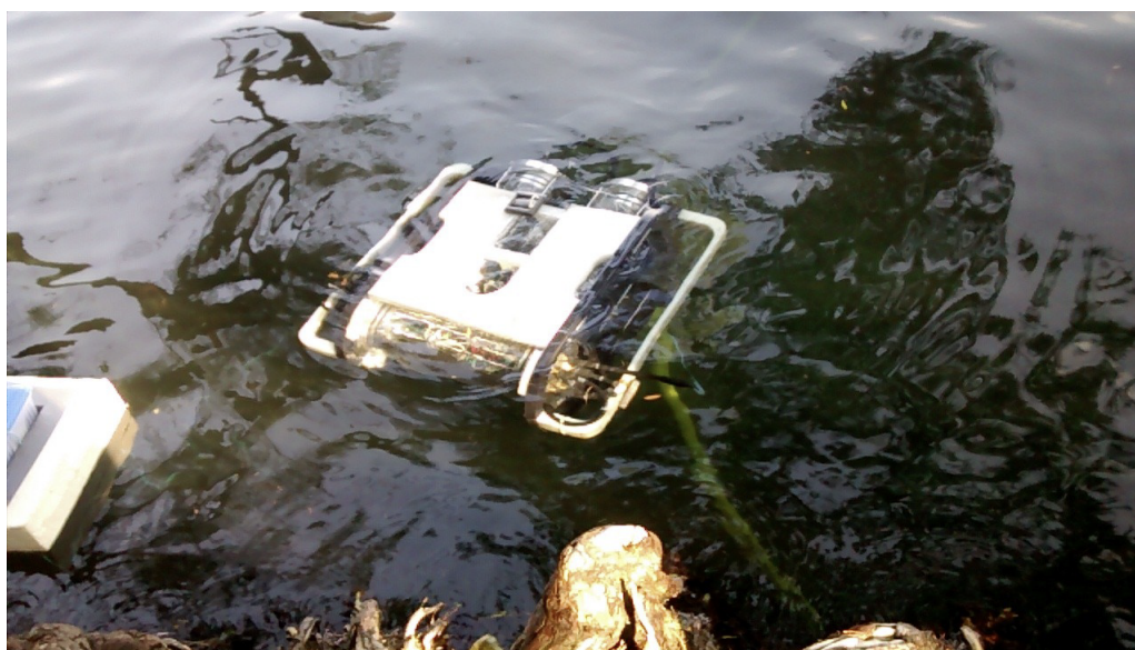
FIGURA 3.27: SEGUIMIENTO DEL DUCTO EN UN LAGO
