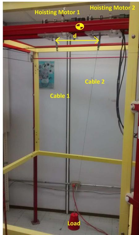
Figura 3.4: Prototipo en laboratorio de la grúa
