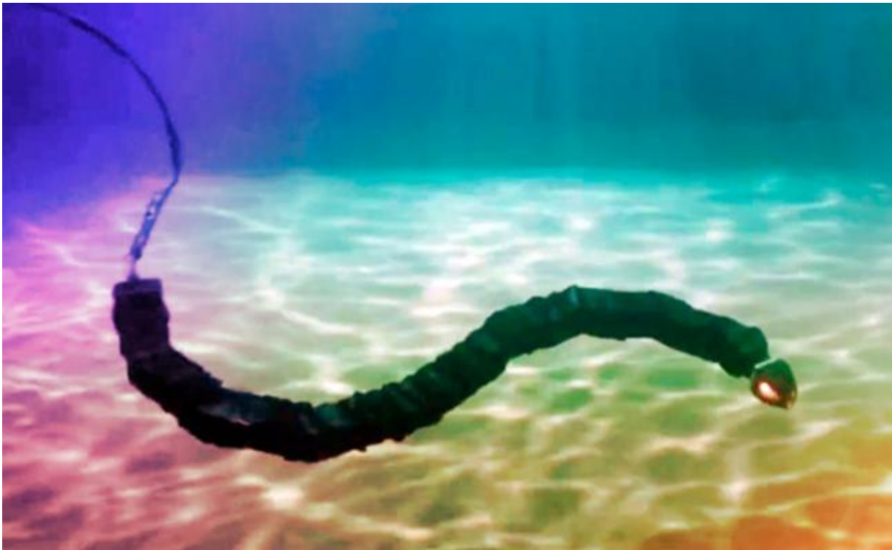
Figura 1.5. Dispositivo Envirobot para el monitoreo de zonas tóxicas en el agua [8].
