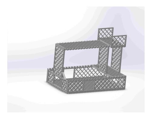
Figura 6.7: Diseño CAD de la bse para Pixhawk
