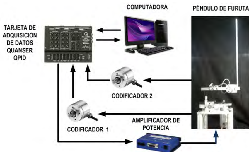
Figura 4.4: Diagrama de bloques del esquema control para el péndulo de Furuta
