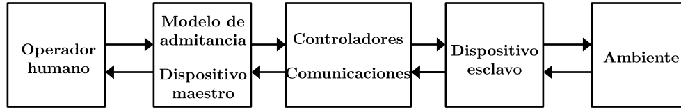
FIGURA 3.1: Esquema de control general basado en el modelo de admitancia en el sitio local.
