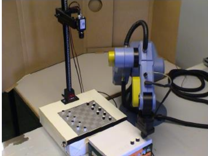
Figura 1.10. Robot manipulador diseñado para un juego de damas mediante sistema de visión
