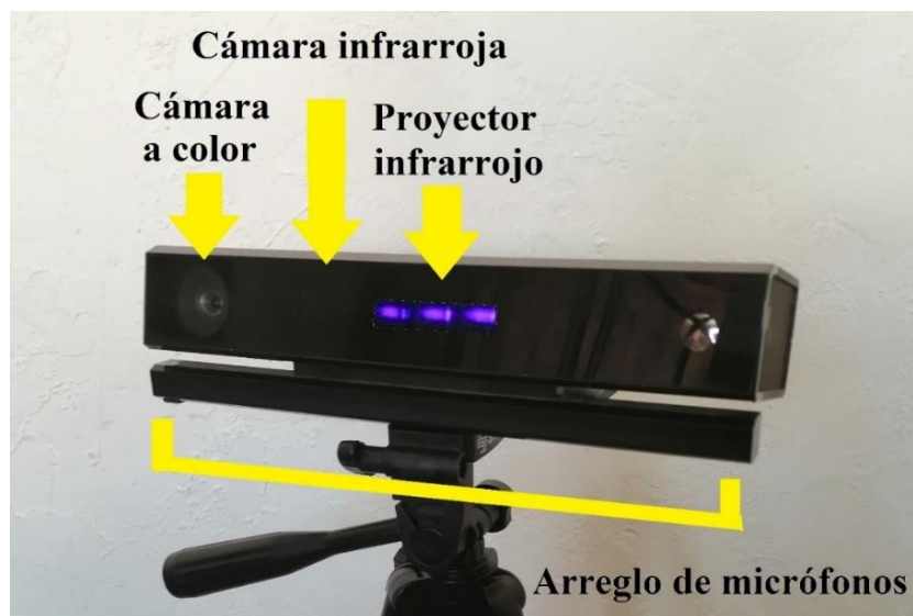
Figura 2.4. Componentes del sensor Kinect V2
