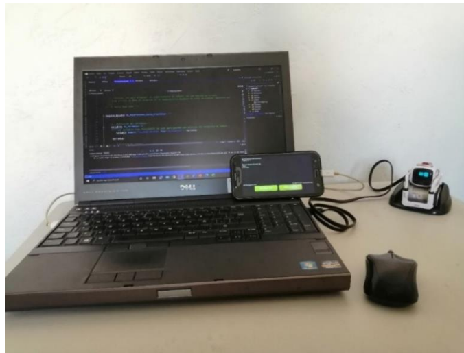
Figura D.1. Conexión del robot Cozmo con la computadora y el teléfono celular
