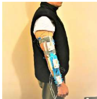
Figura 4-10 Prueba de órtesis con actuación y control en voluntario adulto sano.
