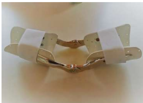
Figura 4-4 Primer prototipo de órtesis personalizada básica hecha de material termoplástico y una articulación metálica bloqueable.
