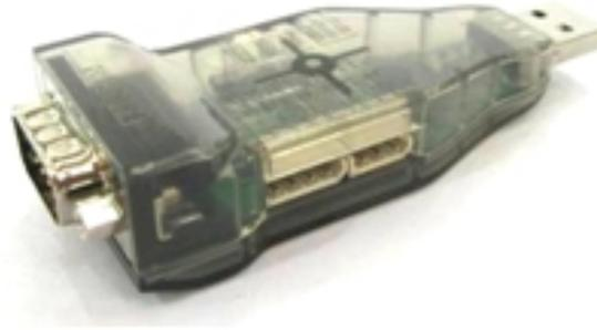
Figura 2.6: Adaptador USB2Dynamixel para comunicación con computadora [5].
