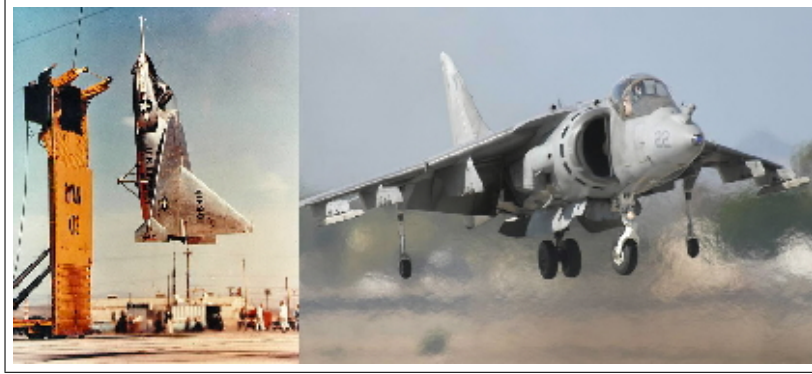
Figura 1.1: Aviones de despegue vertical: Izq. Ryan X-13, Der. Harrier
