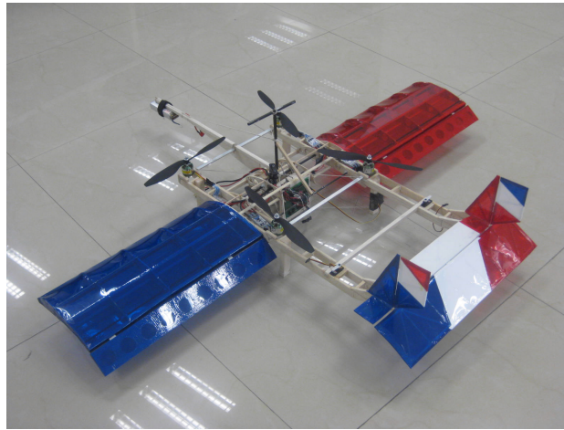
Figura 4.7: Vista posterior del prototipo La Raie Manta
