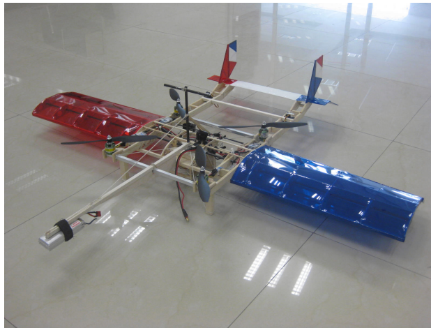
Figura 2.1: Prototipo del mini-UAV La raie manta
