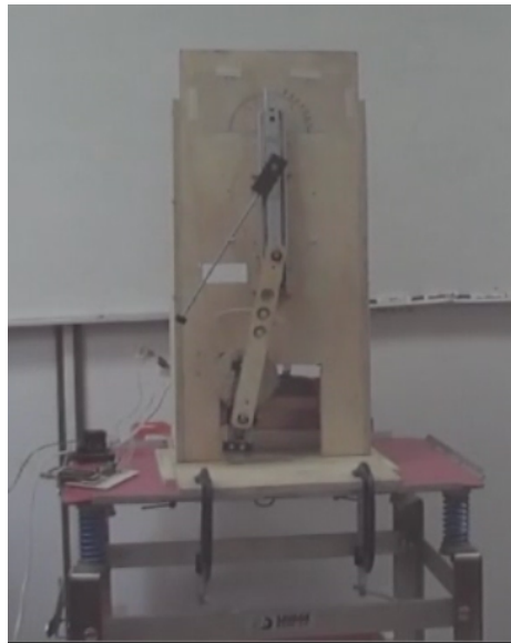
Figura 3-21. Fotografía del prototipo del péndulo de Kapitza sobre la mesa vibrante.
