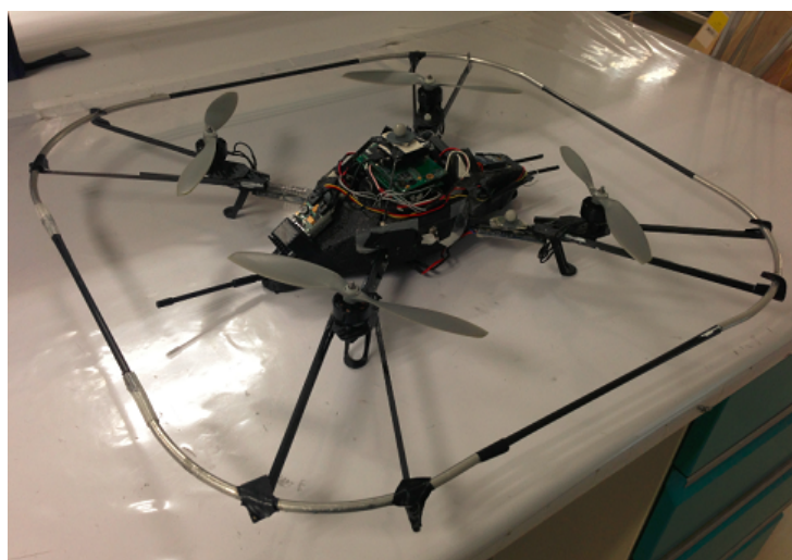
Figura 1.2: Fotografía del vehículo aéreo autónomo (Quadrirotor) desarrollado como proyecto de investigación en el laboratorio de la UMI-LAFMIA del Cinvestav.
