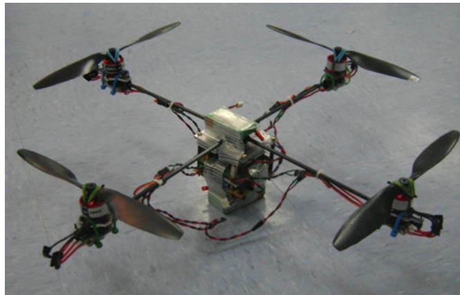
Figura B.1: Quadrirotor elaborado sobre una estructura de fibra de carbono.
