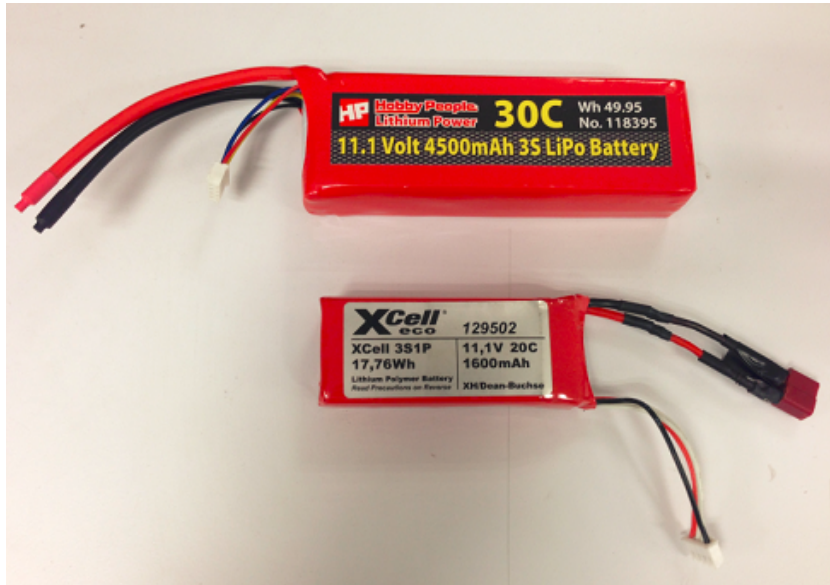
Figura B.11: Baterías de polímero de litio (Li-Po) utilizadas para el suministro de energía del Quadrirotor.
