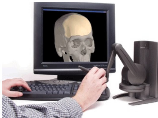
Figura 2.15: El dispositivo háptico Geomagic Touch X, una versión del diseño Phantom usado en CAD [14].
