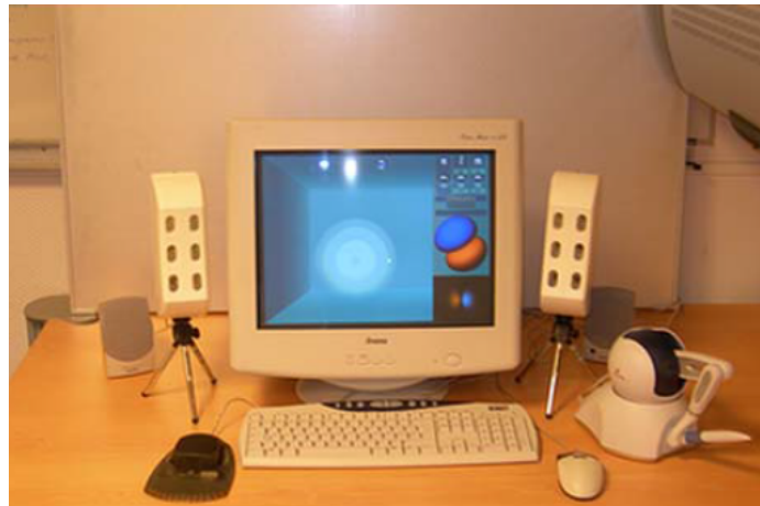
Figura 2.24: Simulador de interacciones entre partículas basado en dispositivo háptico [19].
