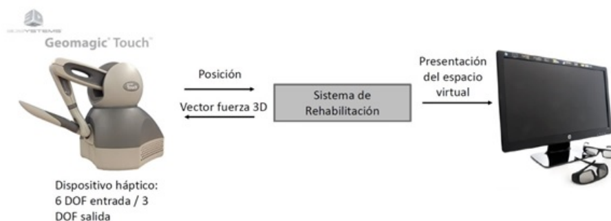
Figura 3.1: Elementos del sistema.
