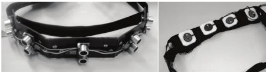
Figura 3.3: Cinturón con sensores ultrasónicos
