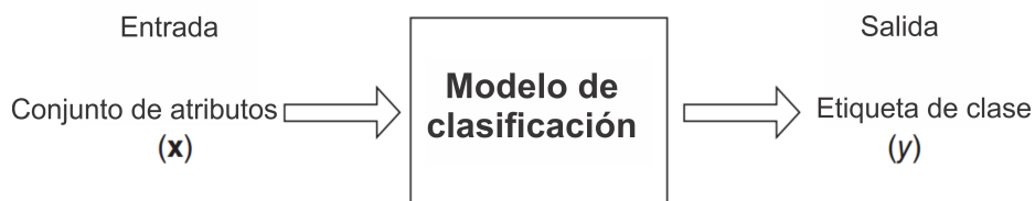
Figura 2.1: Diagrama del funcionamiento de un modelo clasificador.
