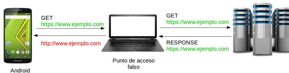
Figura 4.6: Esquema general de la degradación HTTPS a HTTP durante un Ataque de husmeo
