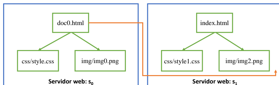
Figura 5.16: Referencias locales y remotas de los archivos doc0.html e index.html , en el que además se aprecia que doc0.html tiene una referencia hacia un recurso que no existe (link roto).
