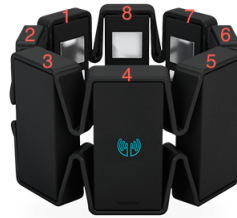
Figura 3.1: Dispositivo Myo. Es una banda que se coloca alrededor del antebrazo.
