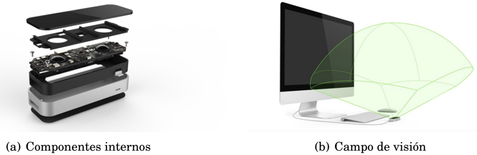
Figura 2.1: Vista de los componentes internos (a) y del campo de visión de 150° (b) del dispositivo.
