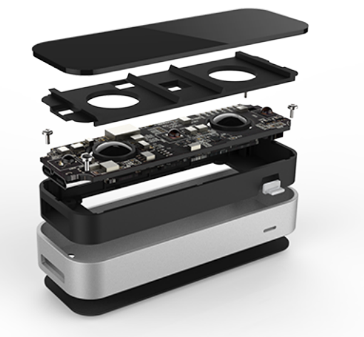
Figura 3.2: Componentes del dispositivo Leap Motion [3].
