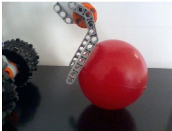
Figura 17.- Detalle de la garra incorporada al robot
