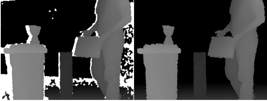
Figura 3.6: Resultado del proceso de inpainting : a la izquierda se muestra la imagen original y a la derecha la imagen después del proceso de inpainting
