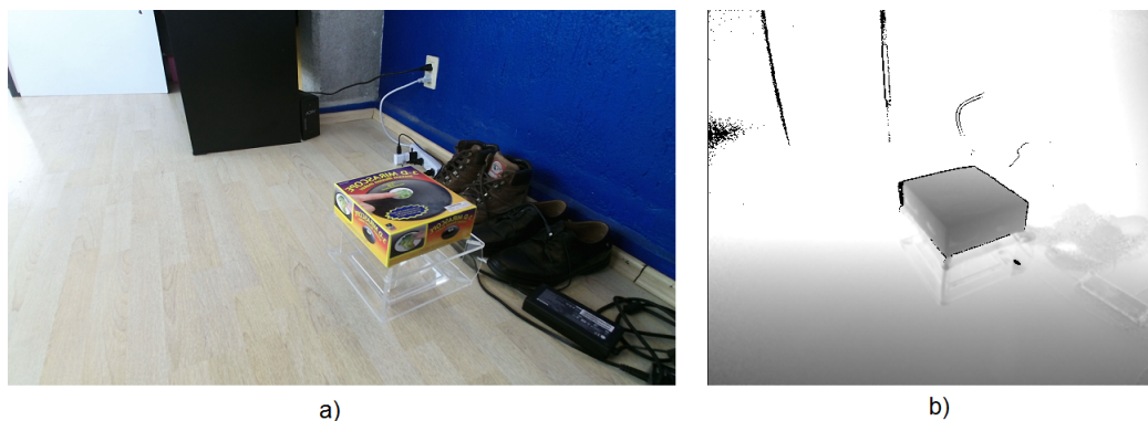
Figura 4.1: En a) se puede observar la imagen RGB, la cual ha sido escalada por motivos de presentación, pero el lector debe considerar que esta imagen es varias veces mayor que la de profundidad y que posee una relación de aspecto distinta. En b) se muestra la imagen de profundidad en bruto, aún sin haber sido tratada con la técnica de inpainting descrita en la Sección 3.2
