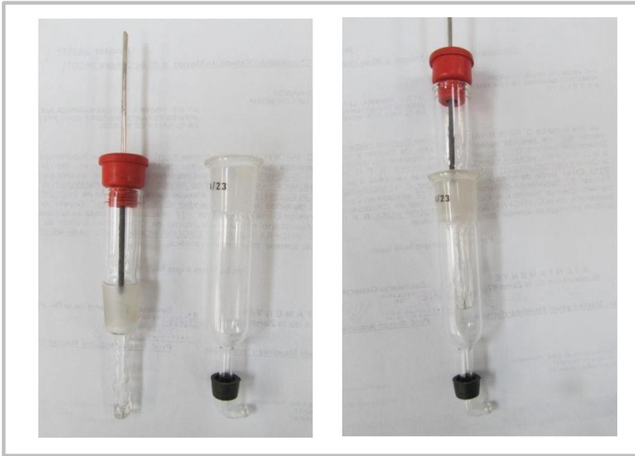
**Figura 10.** Electrodo de referencia Ag/AgCl.
