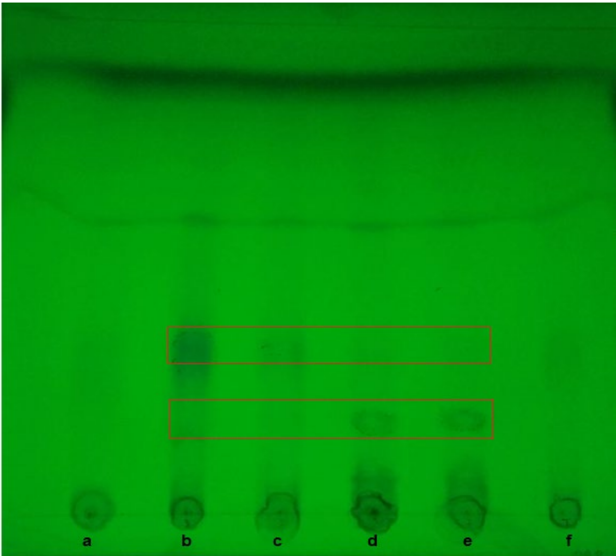
Figura 19. Cromatografía en capa fina de sílica gel (TLC) de ácidos orgánicos sintetizados por A. nigrkans con PDA como fuente de nitrógeno y fosfato, incubado a 28°C y 125rpm. Los carriles corresponden a: a) Blanco, b) 24h, c) 72h, d) 120h, e) 168h, f) Testigo.
