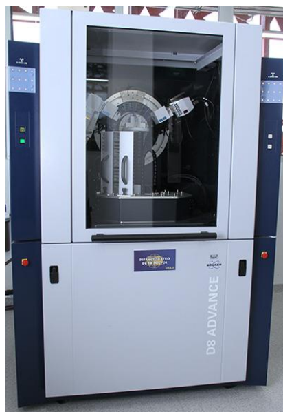
Figura 4. Difractómetro de Rayos X, modelo D8 ADVANCE DAVINVI, de la facultad de química de la UNAM.
