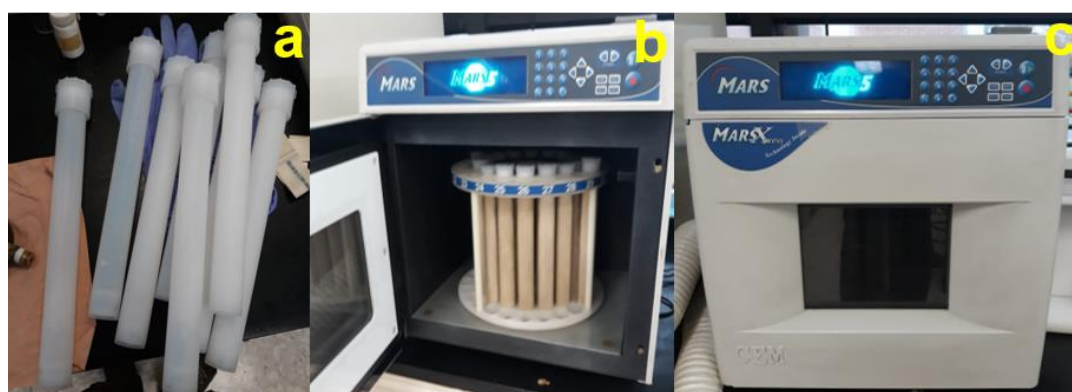
Figura 9. Digestión de muestras a) tubos de teflón b) carrusel con muestras c) sistema de reacción acelerado por microondas, modelo MARSxpress.
