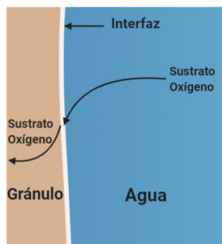
Figura 1.3 Transferencia de masa a través de un gránulo
