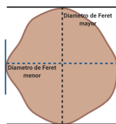
Figura 5.2 Caracterización del diámetro de Feret
