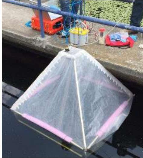
Figura 6.8. Foto real de la cámara piramidal en pruebas de campo
