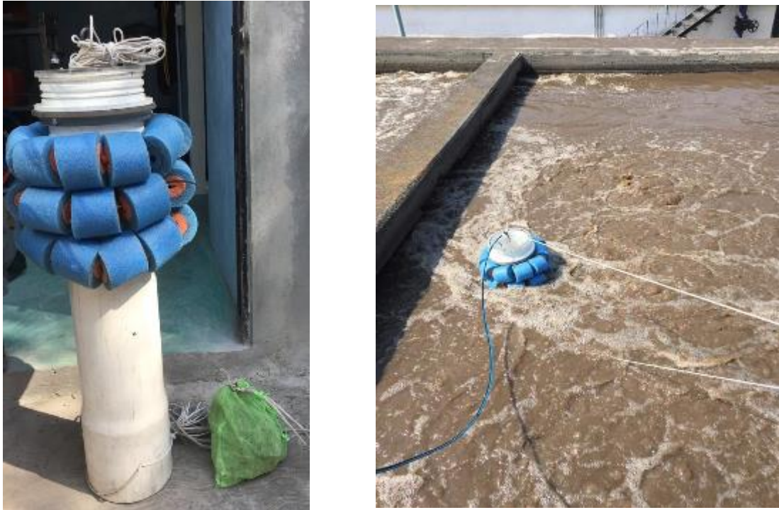
Figura 6.10.- Foto de la CEA real y foto de la CEA en operación en campo
