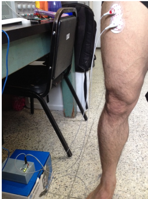
Fig. 4.6: Colocación de electrodos en músculo recto femoral del voluntario.
