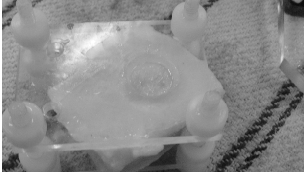
Fig. 6 Montaje de las muestras biológicas en el sujetador después de ser limpiadas y cortadas.
