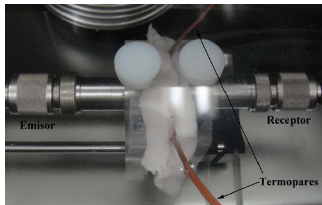
Fig. 1. Fotografía del montaje utilizado en la medición de la atenuación del ultrasonido en tejidos biológicos suaves.
