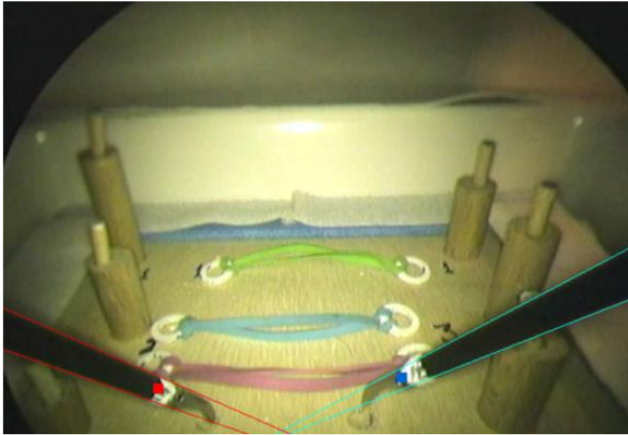
Figura 2.13 Sistema EVA basado en el análisis de la imagen 2D del endoscopio, imagen tomada de Oropesa et al.,(Oropesa, Sanchez-Gonzalez et al. 2013).
