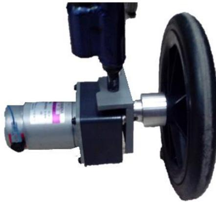
*Fig. 30. Acoplamiento de Motor con Rueda.*
