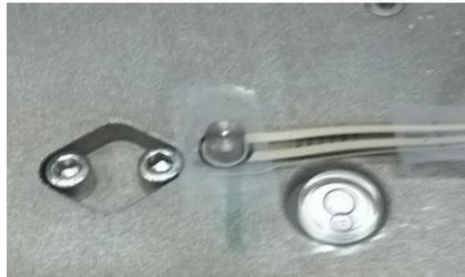
*Fig. 25. Piñón metálico y sensor de fuerza.*
