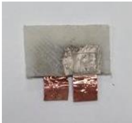
Figura 18. Placa de PVDF con contactos de cobre
