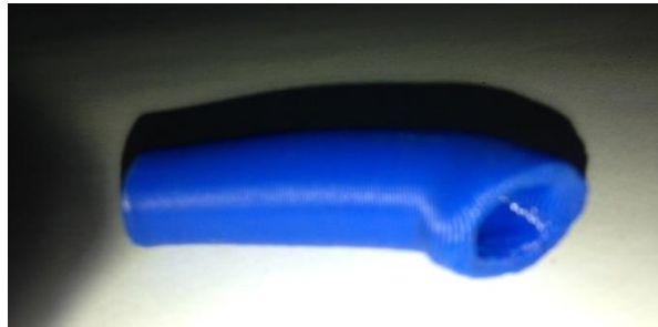
Figura 35. Manufactura de conducto auditivo impreso en ABS
