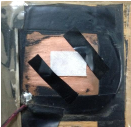
Figura 21. Placa de PVDF en electrodo de cobre.
