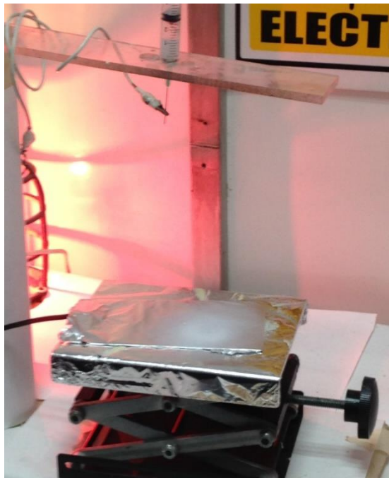
Figura 31. Fabricación de membranas por electrospinning
