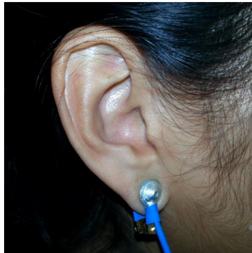
Fig. 3.17.- Electrodo de referencia conectado al lóbulo derecho del sujeto de prueba.
