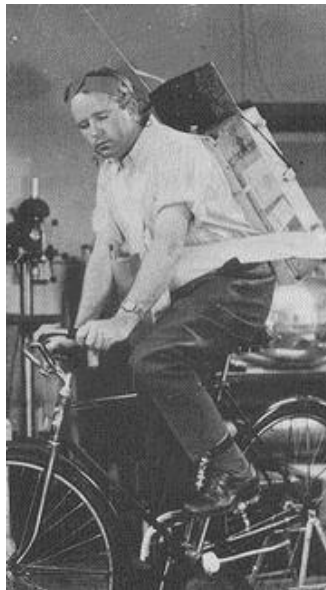
Fig. 2.17. Primer prototipo para hacer registros de ECG ambulatorio, pesaba 38 kg y tenía un alcance máximo de 10 m [12].
