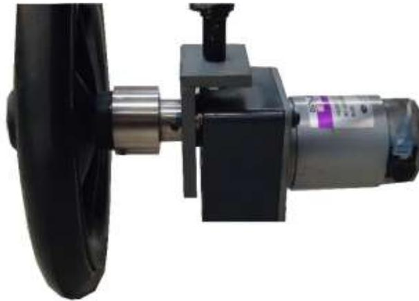
Figura 31. Acoplamiento de Motor con Rueda.
