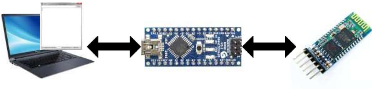
Figura 32. Representación de la conexión para la programación del HC-05.
