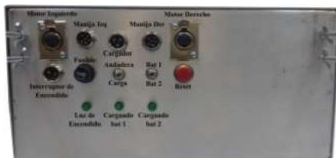
Figura 45. Parte posterior Caja de control.
