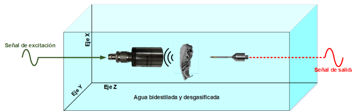
Figura 5.8: Arreglo para la medición del campo acústico a través del cráneo de rata.
