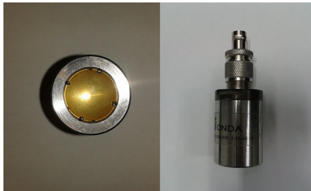
Figura 5.1: Transductor para Ultrasonido Focalizado, en el lado izquierdo se muestra la cara frontal del transductor (PZT).
