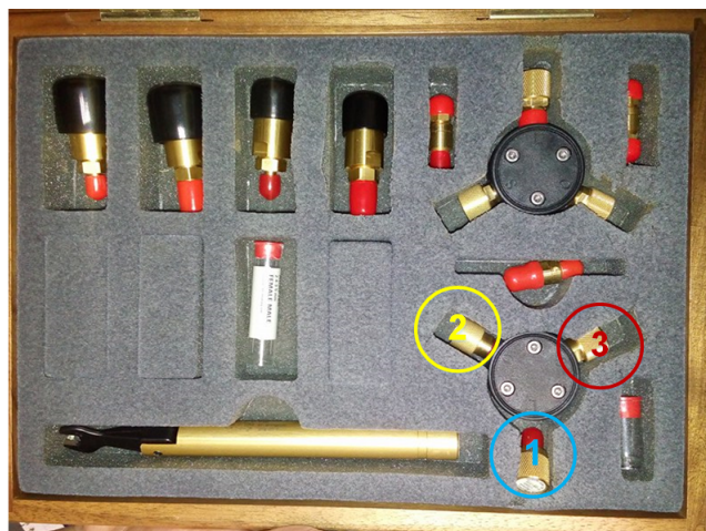
Figura 5.5: Equipo de calibración para el analizador de redes, en el orden en que se conectan los dispositivos de calibración, (1) Short, (2) Open, (3) Load.
