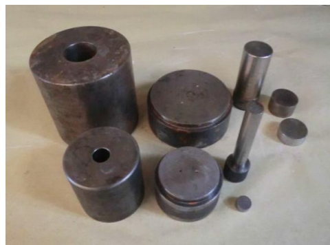
Figura 8. Moldes utilizados en el proceso de fabricación de cerámicas ferroeléctricas
