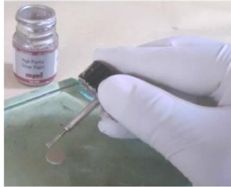
Figura 13. Colocación de electrodos en las caras de las cerámicas con pintura de plata.
