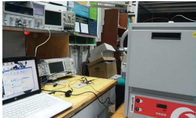
Figura 29. Equipo utilizado para el análisis de las cerámicas piezoeléctricas en tiempo real, para respuestas en frecuencia, a temperatura ambiente y en altas temperaturas.
