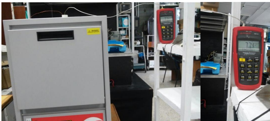
Figura 23. Horno y termómetro para las pruebas en frecuencia a las cerámicas a temperatura de 75 grados centígrados.
