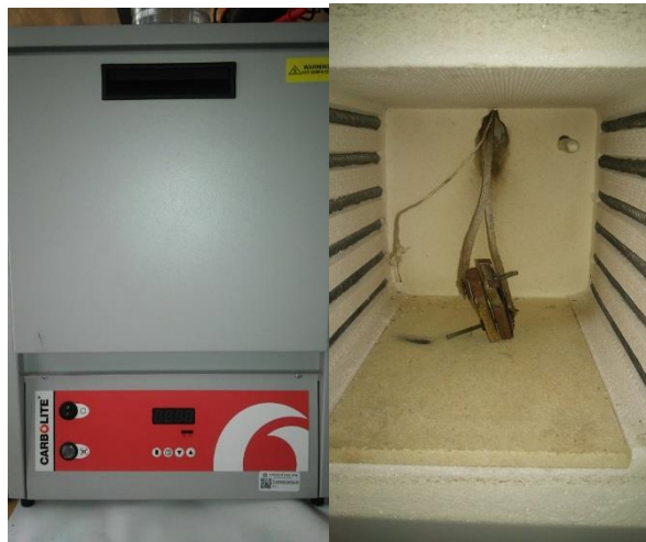
Figura 17. Horno Carbolite 1100, empleado para someter a las cerámicas a altas temperaturas para la obtención de la Temperatura de Curie.
