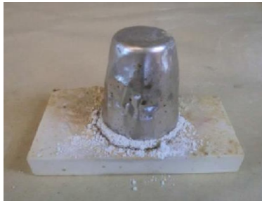
Figura 10. Crisol de platino utilizado para el sinterizado de las pastillas cerámicas.
