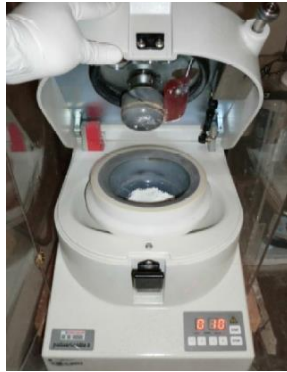
Figura 7. Molino electrónico Fritsch pulverisette 2 y mortero de ágata.
