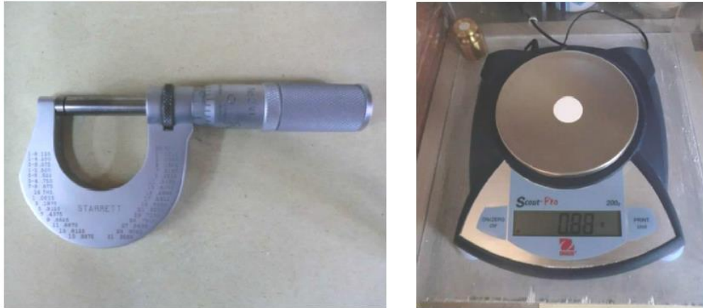
Figura 12. Micrómetro y báscula electrónica para la obtención de las medidas físicas de las cerámicas.
