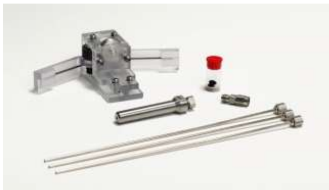
Fig. 6.16: Kit de puntas de prueba para la medición de las propiedades dieléctricas 85070, Agilent Technologies.
