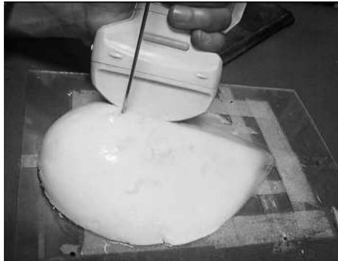
Fig. 6.20: Montaje para la medición experimental de las propiedades dieléctricas de los phantoms.
