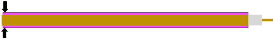
Fig. 6.8: Prensado del extremo distal (señalado con las flechas) para cortocircuitar los conductores del cable.
