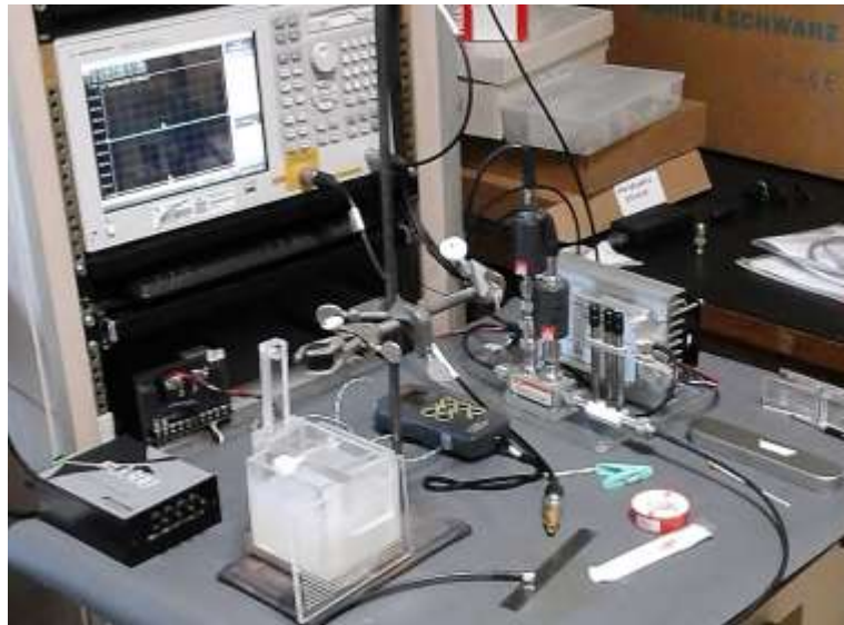
Fig. 7.19: Montaje experimental para la realización de las pruebas de potencia en phantoms.
