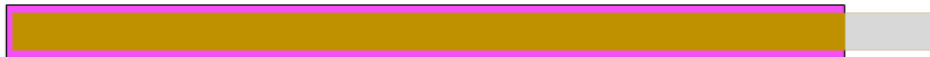
Fig. 6.6: Remoción del cobre del extremo del cable para exponer el dieléctrico (gris).
