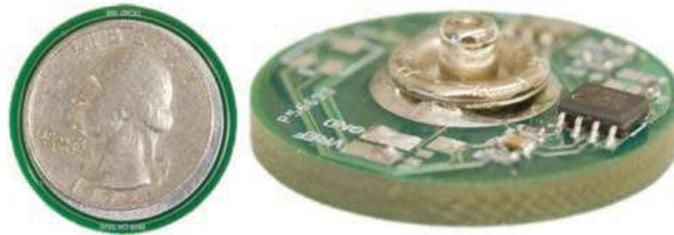
Fig. 12 Electrodo capacitivo reportado en [16].
