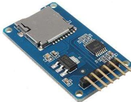
Fig. 36 Tarjeta CATALEX interfaz entre el dsPIC y la micro SD.
