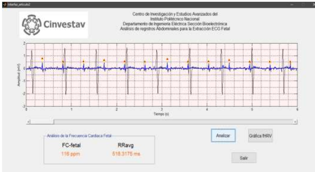
Figure 40. Interfaz de usuario para el análisis estadístico del ECGf y detección de ondas R
