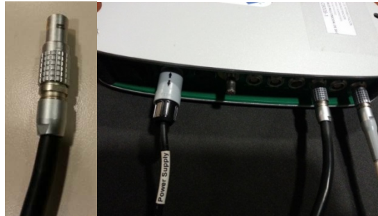
Figura 12. Conexión de la salida del microcontrolador a una entrada digital del amplificador g.Tec.
