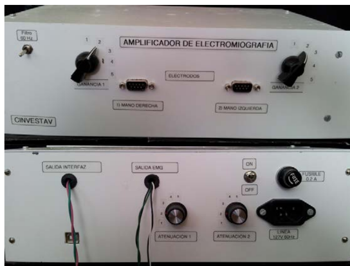
Figura 10. Vista anterior (arriba) y posterior (abajo) del amplificador de EMG construido.
