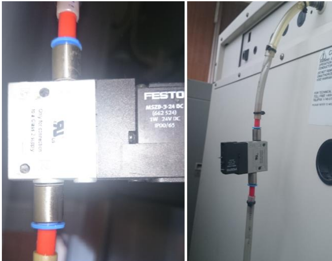
Figura 3.18 Modelo de la electroválvula y parte posterior de la cámara donde se colocará la electroválvula.
