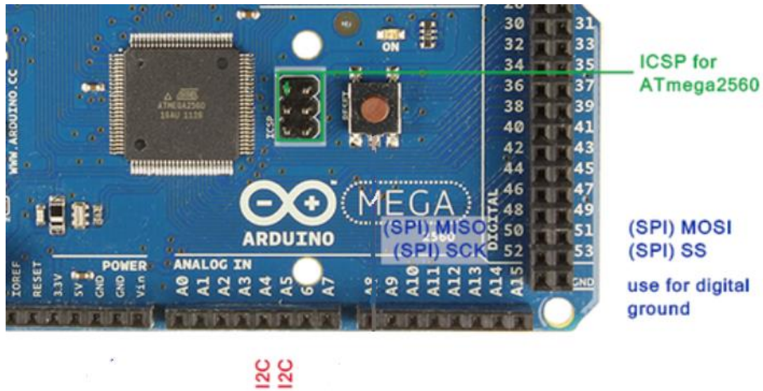
Figura 3.16 Pines donde llegaría la pantalla hacer sus protocolos de comunicación, I 2 C y SPI.
