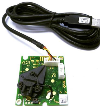
Figura 3.5 Módulo de medición de K-33 BLG conectado al driver UART-USB.
