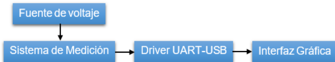
Figura 3.1 Diagrama a bloques del sistema de mediciones de temperatura, humedad y dióxido de carbono, para la PC.
