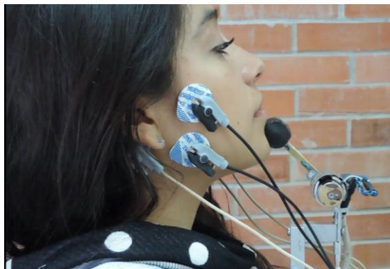
Fig. 21 Golpe sobre la mandíbula del sujeto de prueba para evocar el Reflejo Inhibitorio Masetérico
