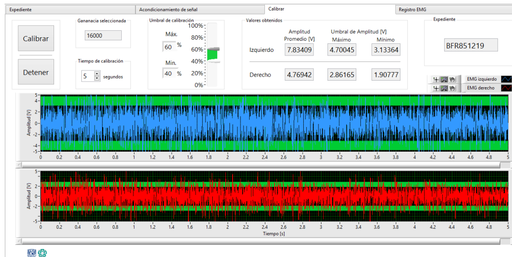
Fig. 12 Interface de Usuario 1 → Calibración. Ventana de ajuste, el usuario fija los umbrales de calibración (porcentajes del valor promedio de la contracción máxima voluntaria ejercida por el sujeto de pruebas). Las graficas despliegan en color verde el umbral seleccionado sobre la señal EMG adquirida.
