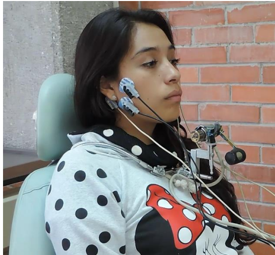
Fig. 19 Colocación de electrodos y Sistema Mecánico en un sujeto de prueba
