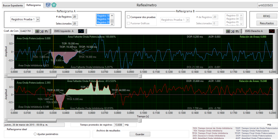
Fig. 16 Interface de Usuario 2 → Reflexigrama. Ventana que despliega el reflexigrama creado a partir de los registros seleccionados y los parámetros obtenidos de esta señal.
