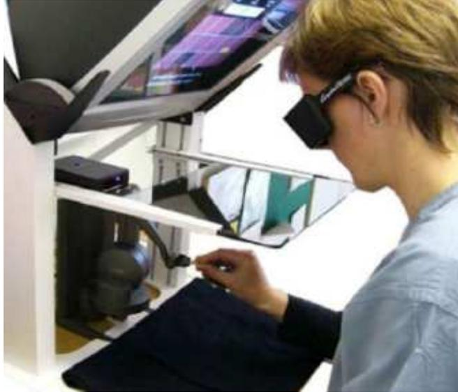
Fig.13: Simulador con retroalimentación háptica y realidad aumentada
