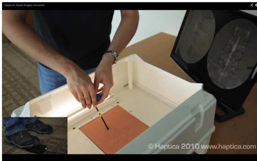
Fig.20: En este modelo se observa una mejora del MIS Spine Simulator, se puede observar que incluye un pedal que simula los disparos del flourosopio
