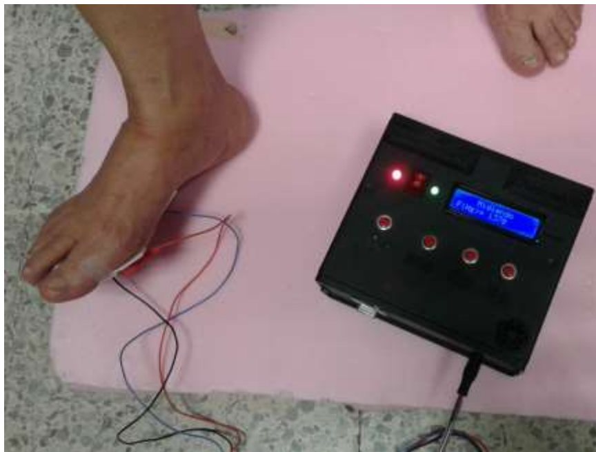
Fig. 35. Técnica de medición de impedancia eléctrica.
