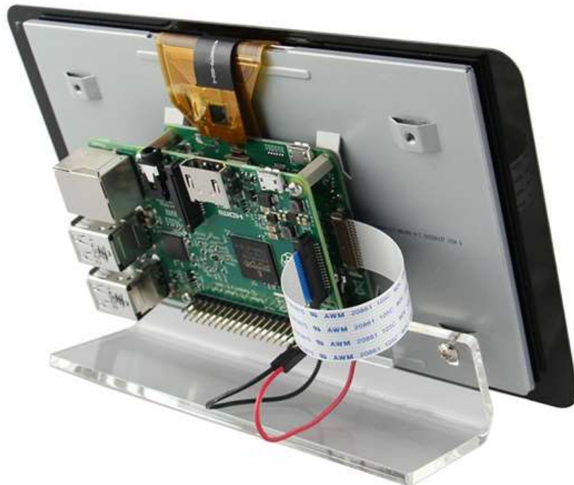
Fig. 27. Conexión de tarjeta raspberry Pi 2 a tarjeta conversor de potencia y señales para pantalla táctil.
