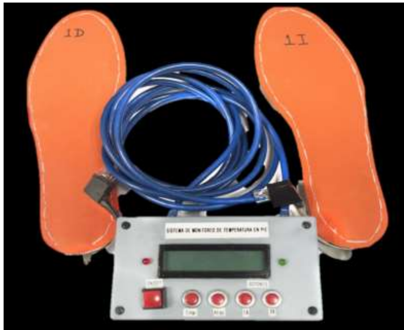
Fig. 31. Sistema de medición de temperatura puntual, plantillas con sensores y cable UTP.
