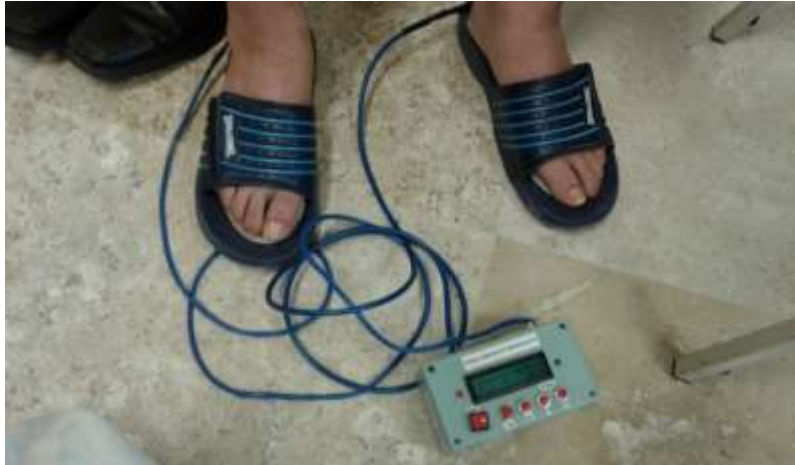
Fig. 34. Medición de temperatura puntual. Las plantillas están dentro de las sandalias.
