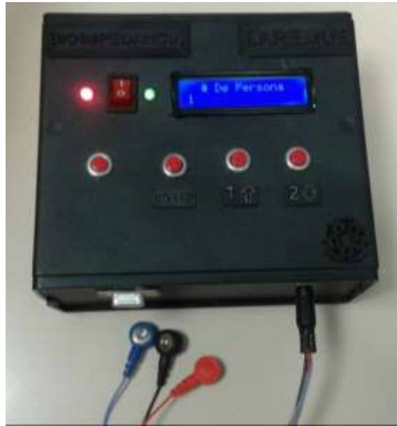
Fig. 29. Sistema de medición de impedancia eléctrica (vista superior).
