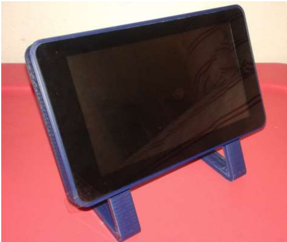
Fig. 37. Fotografía del sistema concentrador y distribuidor de información, impresión de caratula en la impresora 3D.
