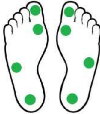
Fig. 23. Zonas que se medirán con el sistema de monitoreo de temperatura de pie diseñado. De arriba hacia abajo: dedo hallux, primer metatarsiano, arco y talón del pie.
