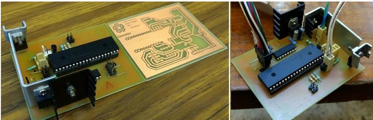
**Figura 4.1** Tarjeta para control de mecanismos y alarmas.
