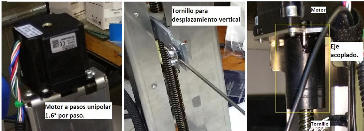
**Figura 3.4** Motor, tornillo sin fin y su ensamble.
