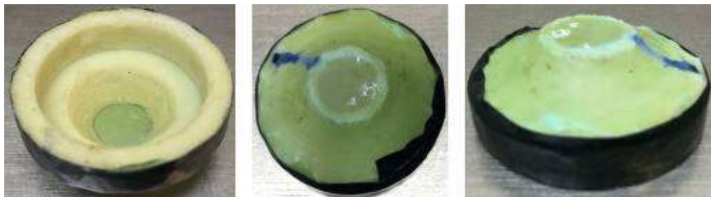
Fig. 6. 13: Cono obtenido e impreso en 3D. Se acopló una película de látex para evitar el derrame del agua con la que será llenado con el fin de brindar un medio de propagación.
