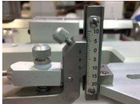
Fig. 6. 45: Sujetador frontal de la rata, fijo a 5 mm. Esta coordenada asegura un sitio correcto en ratas de 210 y 230 g.
