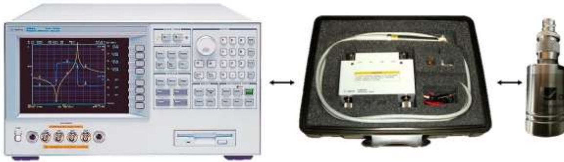
Fig. 5. 2: Configuración para la medición de la frecuencia de resonancia del transductor. De derecha a izquierda se presenta el analizador de impedancias, una sonda de impedancia incluida en el equipo y el transductor FUS.
