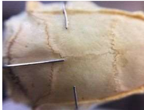
Fig. 5. 7: Colocación de termopares sobre cráneo de rata para registrar el aumento de temperatura que provocan las ondas ultrasónicas.
