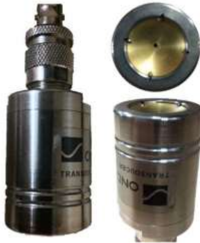
Fig. 5. 1: Transductor FUS Onda Corporation® utilizado para la experimentación. Arriba a la derecha se muestra la cara cóncava del transductor.
