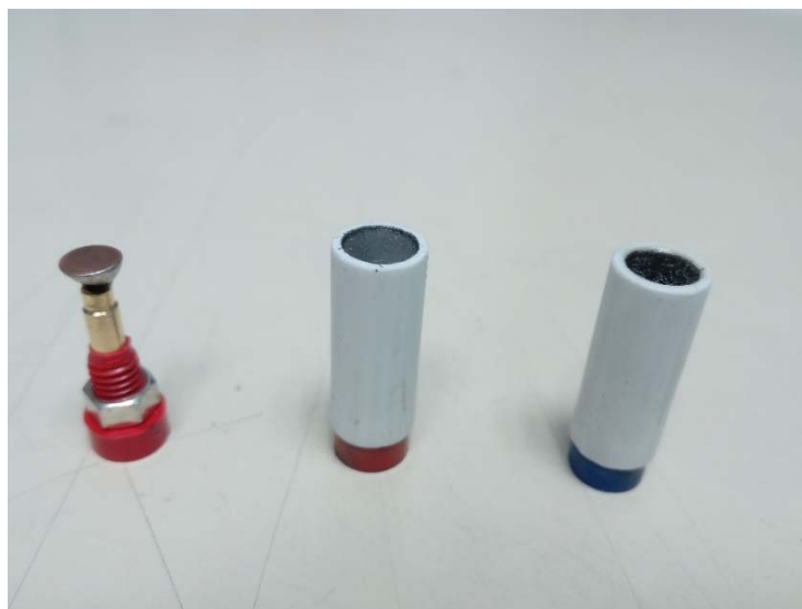
Fig. 4. Etapas del desarrollo de un sensor ISE. A la izquierda se tiene la placa de cobre soldada al conector hembra, en el centro se encuentra dicho conector con la placa dentro del tubo PVC con el transductor después de haberse horneado y a la derecha ISE con la membrana depositada.
