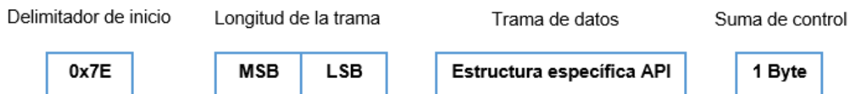
Fig. 11. Estructura de la trama de datos enviada utilizando la operación API
