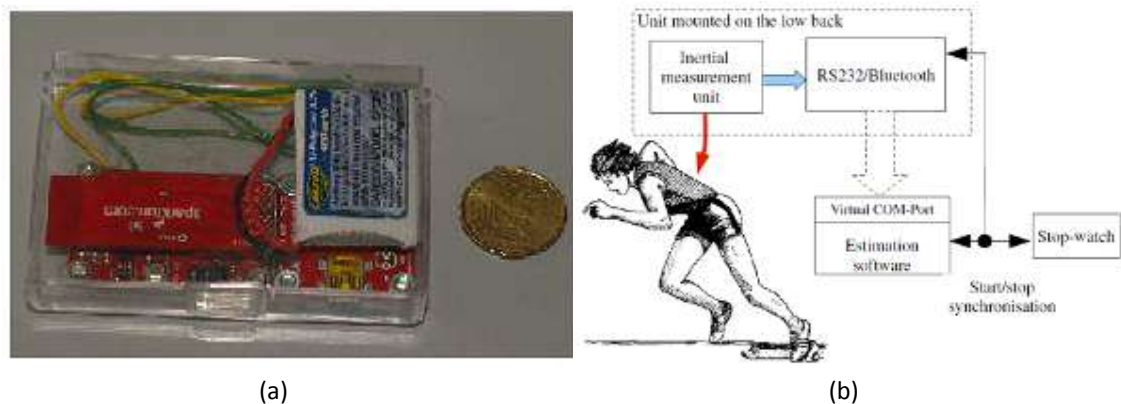
Fig. 2. Sistema de medición inercial para evaluar velocistas [5]. (a) Dispositivo de medición que se coloca en el cuerpo del atleta. (b) Esquema general del sistema.
