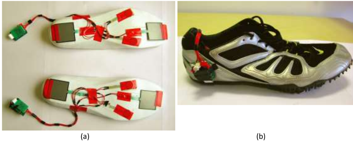
Fig. 1. Plantillas instrumentadas para el estudio del contacto con el suelo al correr [3]. (a) Colocación de los sensores sobre las plantillas. (b) Posición del nodo de medición y transmisión en un spike .
