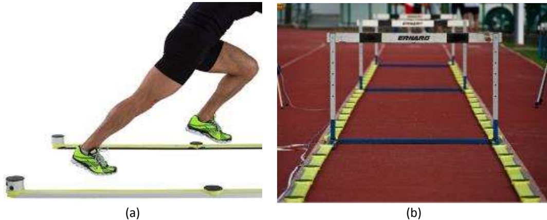
Fig. 13. Sistema Optojump [28] . (a) El sistema se compone de una barra transmisora y una receptora. (b) Arreglo de barras para una carrera de vallas.
